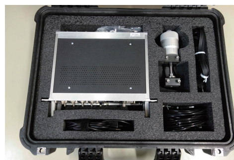
LiniGageキットに含まれるセンサ、電子ラック、ケーブル、CS-1カリブレーション・システム・モデル
